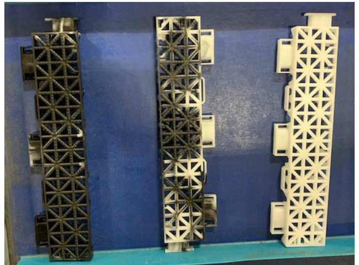
Arriba: Partes de un cambio de color sobre la marcha usando Asaclean PLUS a través de los canales calientes de múltiples cavidades de nuestro cliente.
